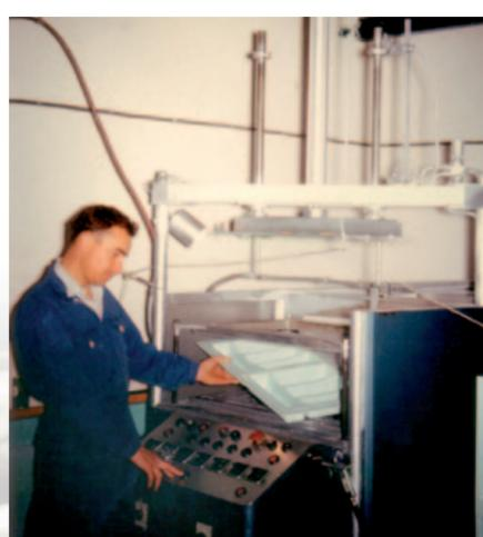
Ouvrier travaillant sur la presse à thermoformer des ramasse-couverts, vers 1980.
