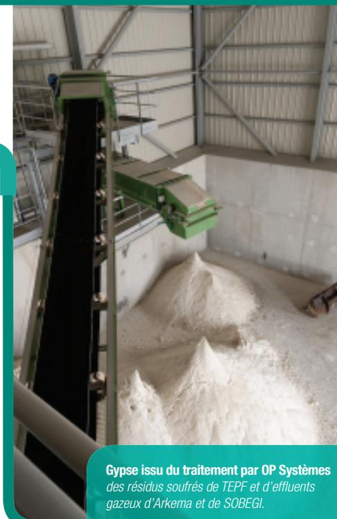
*Gypse issu du traitement par OP Systèmes des résidus soufrés de TEPF et d'effluents gazeux d'Arkema et de SOBEGI.*
