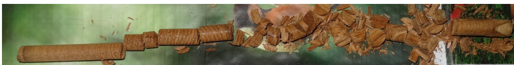
La carotte de la poutre de rive est de la cuisine du pavillon (sauveboeuf41) juste après son extraction.
