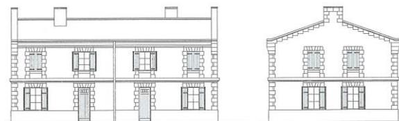
fig. 8 : Élévation d'une maison de quatre logements (mur gouttereau - pignon).
