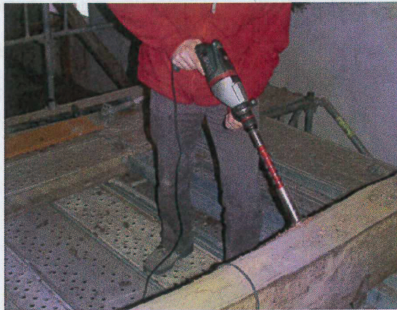
Figure 9 : Prélèvement d'un échantillon à la tarière électrique dans un entrain (ci-dessus).
